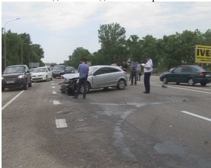
Фото 3. След масла из двигателя Opel Astra
